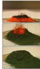
Şəkil 7. Azotun ammonium-bixromatdan alınması
